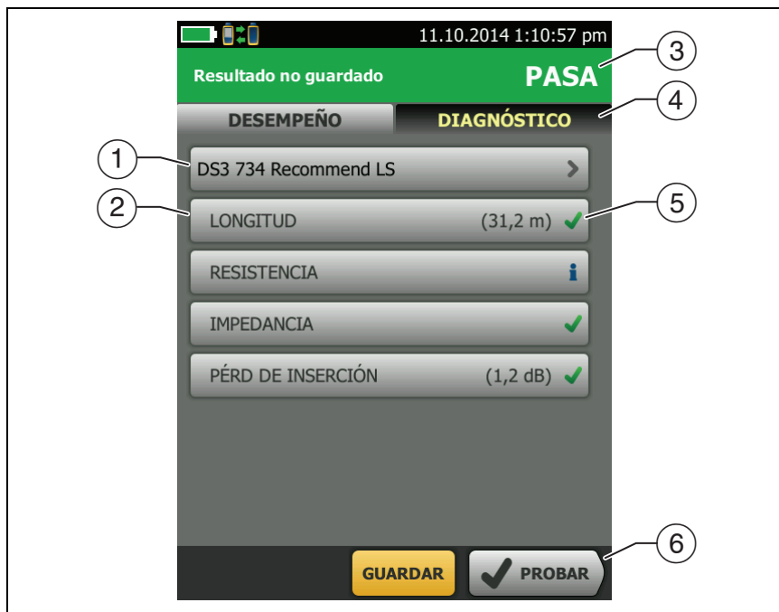
Figura 25. Resultados de la autocomprobación del cableado coaxial
