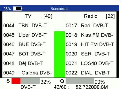
La búsqueda automática permite guardar hasta 1000 canales en los diferentes sistemas de transmisión.
