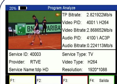
La pantalla de análisis de Transport Stream permite visualizar los principales parámetros de transmisión.
