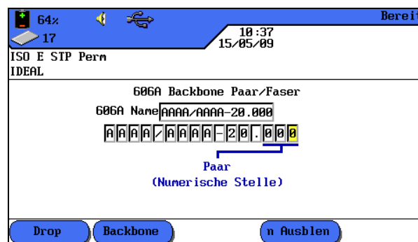
Ilustración 5.4.4. Parámetro de cable 606A Backbone par/fibra
