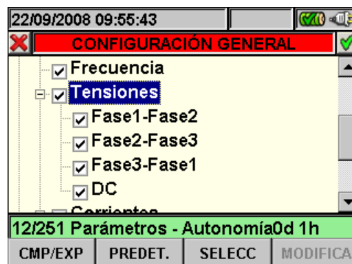
Fig. 94: Subnivel Parámetros Generales – Sistema Fotovoltaico Trifásico
