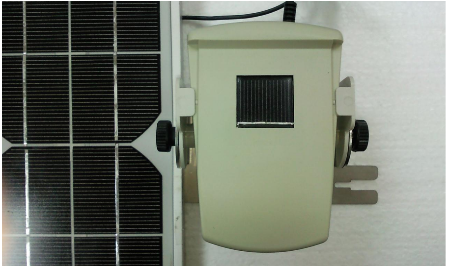
Conexión del panel solar con el detector solar remoto.(visión frontal)
