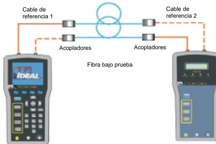
Figura 7: Configuración por el Método 'A'
