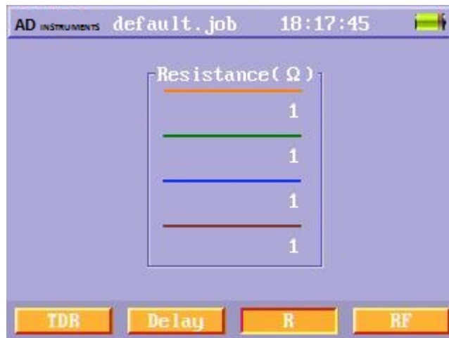
Figura 24 Test Automático de bucle de resistencia en DC
