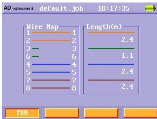
Figure 32 Menú de resultados del test manual del cable de datos TDR (TDR Falla)
