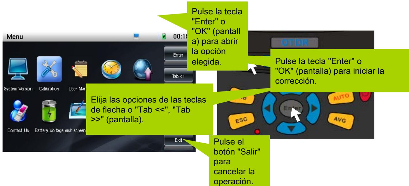
Si detecta una desviación relativamente grande entre los resultados de medición actuales y el resultado de la medición anterior durante un período de tiempo, el usuario puede corregir la desviación a través de la función de "corrección automática". La corrección de los parámetros de medición internos puede mejorar el rendimiento dinámico y normalizar la curva.
