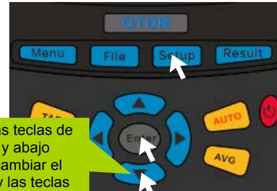
Use las teclas de arriba y abajo para cambiar el valor y las teclas derecha e izquierda para cambiar el dígito.
