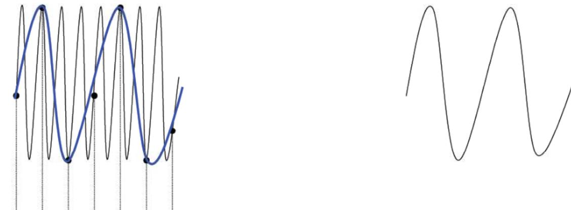
**3. Forma de onda con lagunas:** cuando la frecuencia de muestreo es demasiado baja, la forma de onda reconstruida a partir de los datos del muestreo no refleja toda la información de la señal real.
