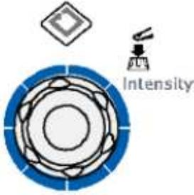
Ajusta el brillo de la forma de onda: en el modo sin-menú de operación (el menú de pantalla está oculto), gire este botón para ajustar el brillo de la forma de onda. El rango de ajuste es de 0% a 100%. Gire hacia la derecha para aumentar el brillo y hacia la izquierda para reducir. Presione este botón para restablecer el brillo al 50%. También se puede pulsar **Display** → **WaveIntensity** y utilizar el mando para ajustar el brillo de la forma de onda.
