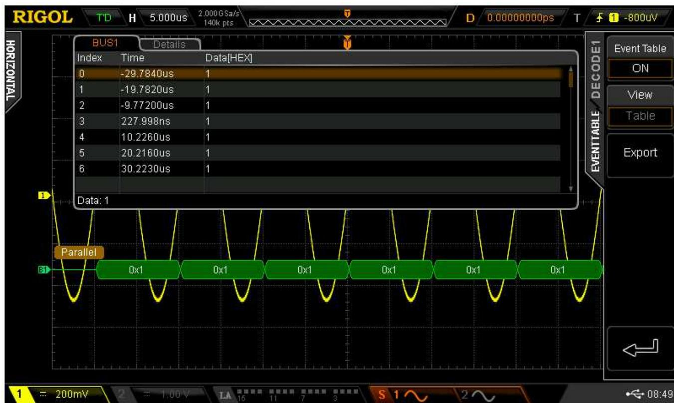
En este punto, "Table" se selecciona en el menú **View** de forma automática y dicho menú está en gris. Los datos descodificados se muestra en formato de tabla siguiendo el orden en el tiempo. Si un dispositivo de almacenamiento USB está conectado al instrumento, pulse Exportar para exportar la tabla de datos al dispositivo de almacenamiento USB externo en formato CSV.
