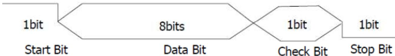
Los osciloscopios MSO2000A / DS2000A se disparan cuando detectan la trama de inicio, la trama de error, error de comprobación o datos especificados de la señal RS232.
