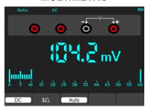
El DS2202P incorpora multimetro de 6.000 cuentas con aislamiento de las entradas del osciloscopio.
