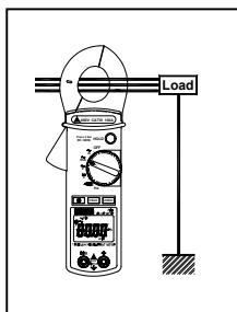
**Nota:** Per ragioni di sicurezza, disinserire i cordoni di misura della pinza prima d'effettuare l'operazione. La misura è ottimale con il conduttore centrato in mezzo alle ganasce
