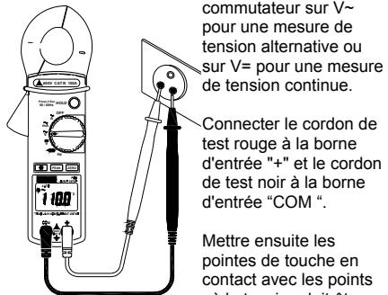
Positionner le commutateur sur  $V\sim$  pour une mesure de tension alternative ou sur  $V=$  pour une mesure de tension continue.
