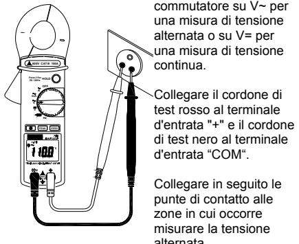
Posizionare il commutatore su V~ per una misura di tensione alternata o su V= per una misura di tensione continua.
