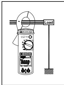
**Note :** Par mesure de sécurité, déconnecter les cordons de mesure de la pince avant d'effectuer cette opération. La mesure est optimale avec le conducteur centré au milieu des mâchoires
