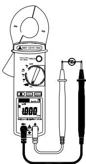
Drehschalter auf **Hz** stellen, um die Frequenz einer AC-Spannung zu messen.
