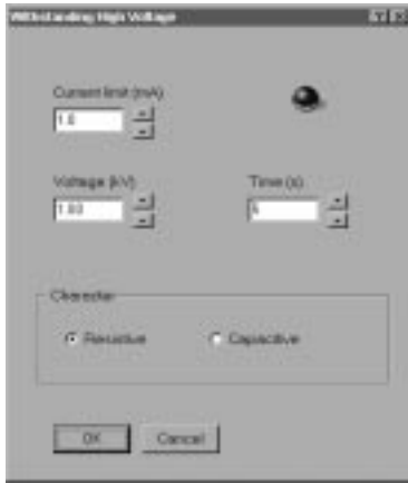
Ventana de parámetros de alta tensión
