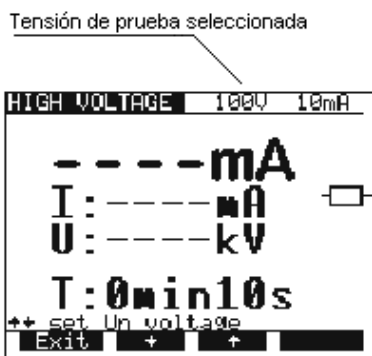
Fig. 5. Menú de selección de la tensión de prueba
